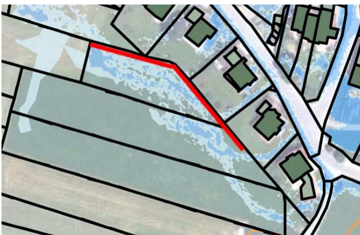
Abb. 12: Fließweganalyse im Plangebiet mit geplanter Entwässerungsmulde (roter Streifen, Quelle: Technischer Bericht, Teamwerk Planungs GmbH, 14.11.2025)
