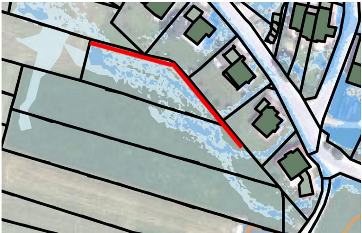
Abbildung 3: Skizzierte Position der Entwässerungsmulde in Rot, mit der das Oberflächenwasser nach Westen abgeleitet wird. Fließwege verlaufen aktuell von rechts oben nach links unten.
